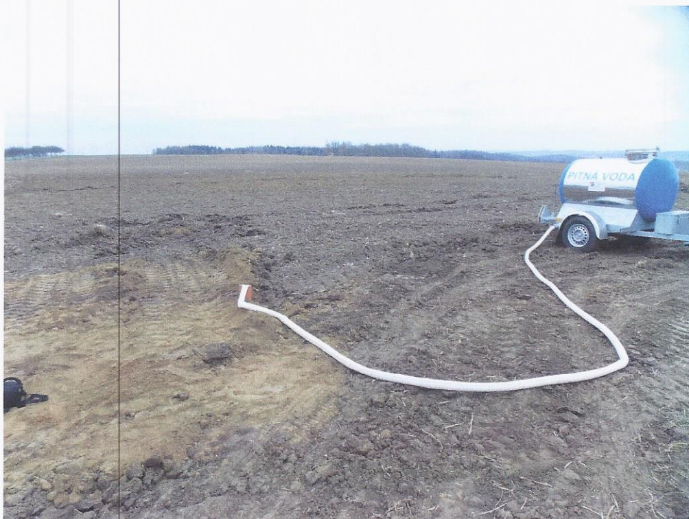
Foto č. 1: Nálevková zkouška na sondě KS-4
